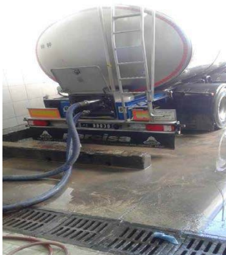
Photo.5 Réception du lait: éviter les pertes dues à un mauvais raccordement
