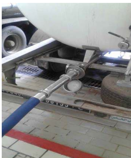
Tuyaux bien raccordés avant de passer le lait ©FAO/ Saaidia Bouali
