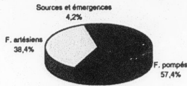
Fig 2 : Répartition de l'exploitation des nappes profondes de la Tunisie par type d'ouvrage
