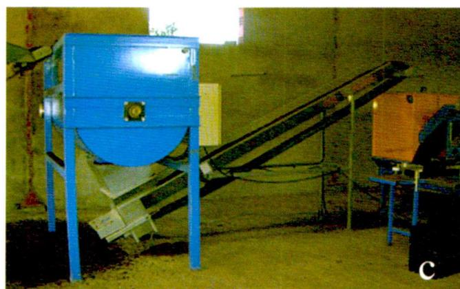
**Photo 2.2 :** Exemple d'une chaîne d'empotage et d'ensemencement mécanisée présente dans certaines pépinières modernes en Tunisie :
