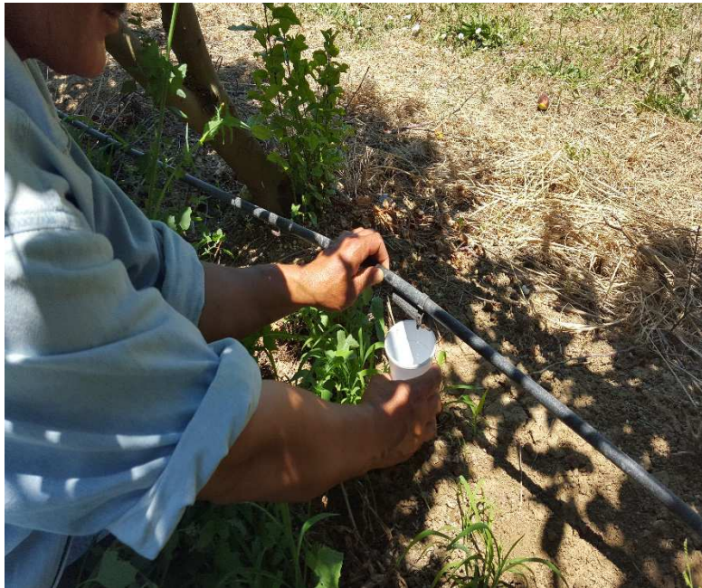
photo 7 : mesure de l'uniformité de la distribution à la parcelle
