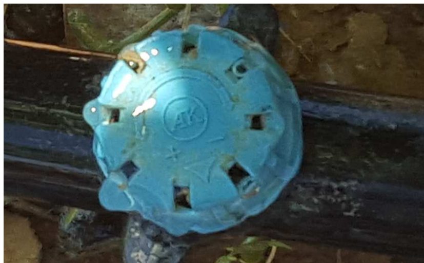
Photo 8 : Goutteur réglable de 0 à 40 l/h
